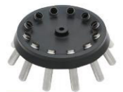
No.1 转子容量: 12x15ml 最高转速: 5500r/min 最大相对离心力: 5310xg
