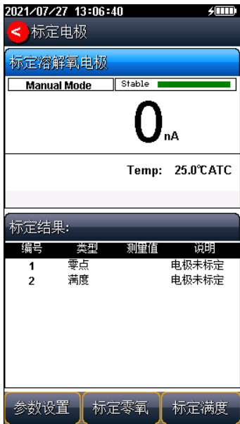
图 5-19 溶解氧标定示意图
