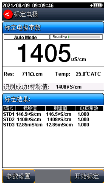
图 5-16 电极常数标定示意图
