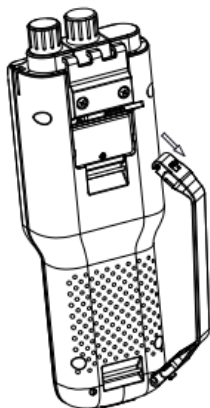
图 4-4 便携式腕带安装示意图
