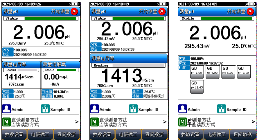
图 5-2 测量参数（从左至右依次为三参数、两参数和单参数） 显示界面示意图
