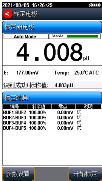
图 5-8 pH 电极标定示意图
