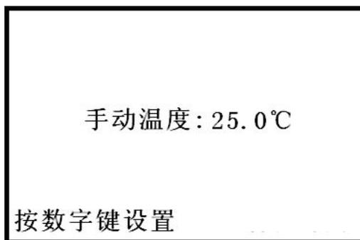
当光标“▶”指手动温度设置参数项时，按“确定”键，仪器显示如上。通过“数字”键设置手动温度值。然后，按“确定”键予以确认，设置完毕，按“取消”键退出手动温度设置状态，仪器进入设置参数状态。手动温度设置范围(0.0~135.0)℃。
