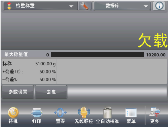
检重称重主屏幕以及检重显示设置为 检重状态
